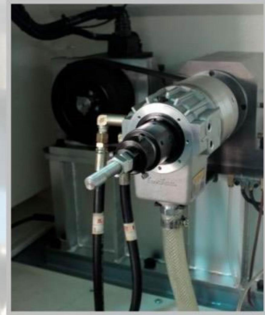
高夾持力，高速中空油壓迴轉缸。
